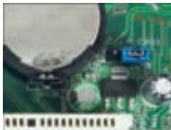
شکل ۱۴ - جامپر Clear CMOS
