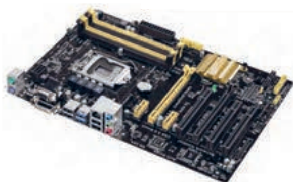
شکل ۸ - برد اصلی با فرم فاکتور ATX
